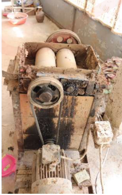
Görsel 7. Çamurun Merdaneden Geçirilme İşlemi
