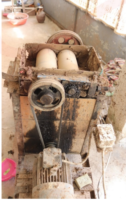
Görsel 7. Çamurun Merdaneden Geçirilme İşlemi
