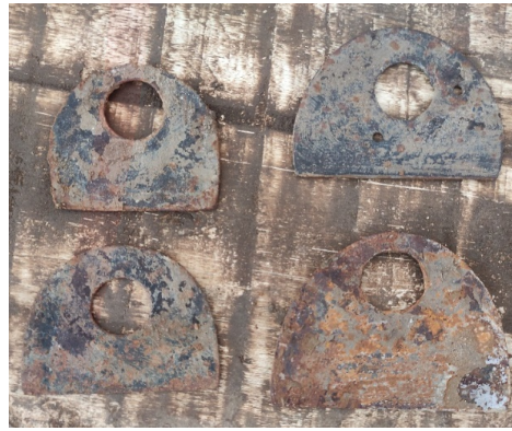
Görsel 9. Şekillendirme Sırasında Kullanılan Zatiyen Adı Verilen El Aletleri (Mayıs 2021)
