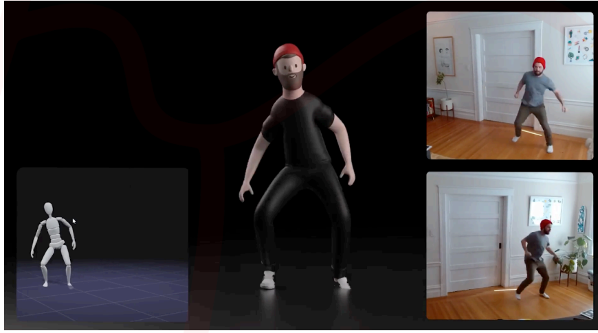
Görsel 14. Çift Kameralı, İşaretçi Kullanılmadan Gerçekleştirilen Hareket Yakalama Örneği (Rokoko)
