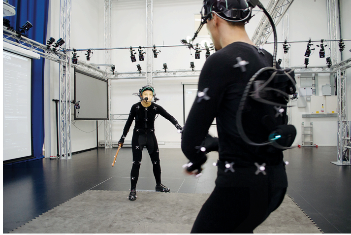
Görsel 5. İşaretçiler Kullanılarak Yapılan Hareket Yakalama İşlemi
