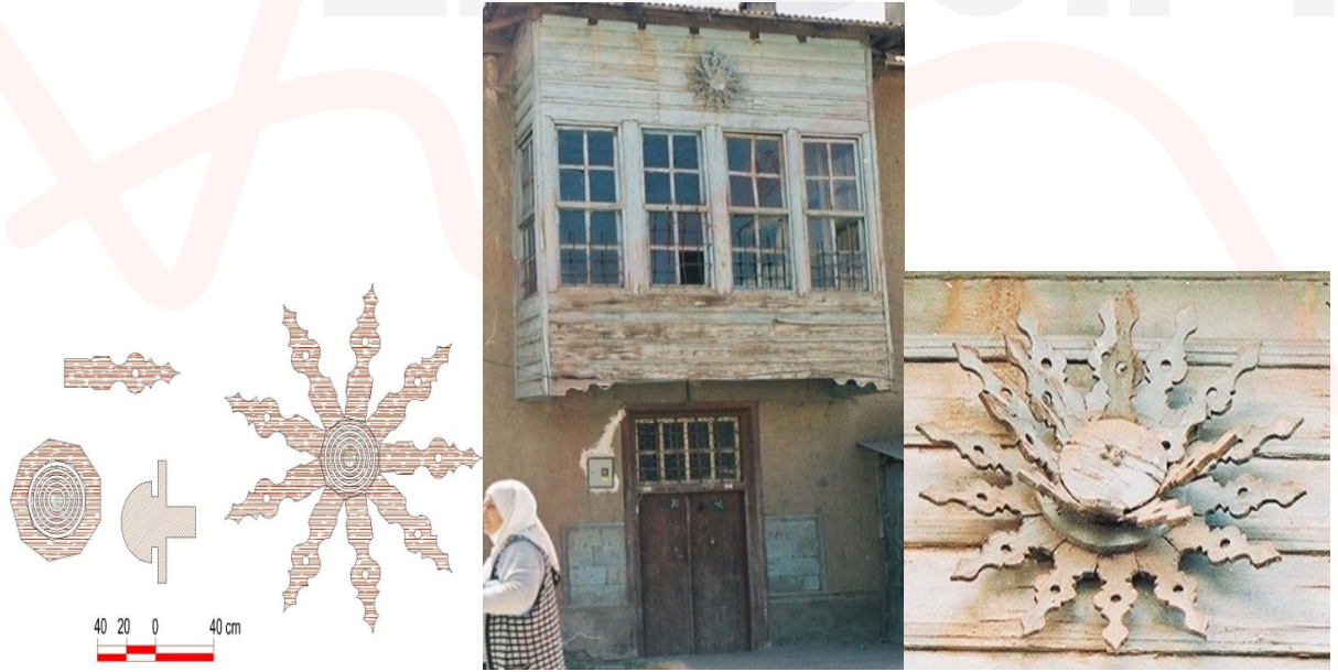
Çizim 23-Görsel 34,35. Cemal Efendi Evi Köşkü Güneş Kursu Motifi Plan, Kesit, Cephe Detayları ve Görünüşleri (Kaynak: Ş. Öztürk-1996)
