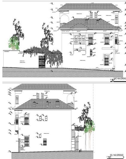
Plan 13: Evin farklı cephe restorasyon kesitleri(M. Yaşar'dan)
