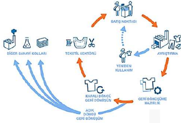
Şekil 11. Tekstil Sektöründe Açık ve Kapalı Döngü Geri Dönüşüm (Dural,2019).
