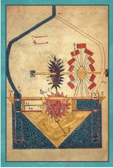
Görsel 13 El Cezeri tarafından tasarlanan Piston sistemi ile suyun naklini sağlayan düzenek. Erişim:16.01.2025 https://tr.wikipedia.org/wiki/Cezer%C3%AE
